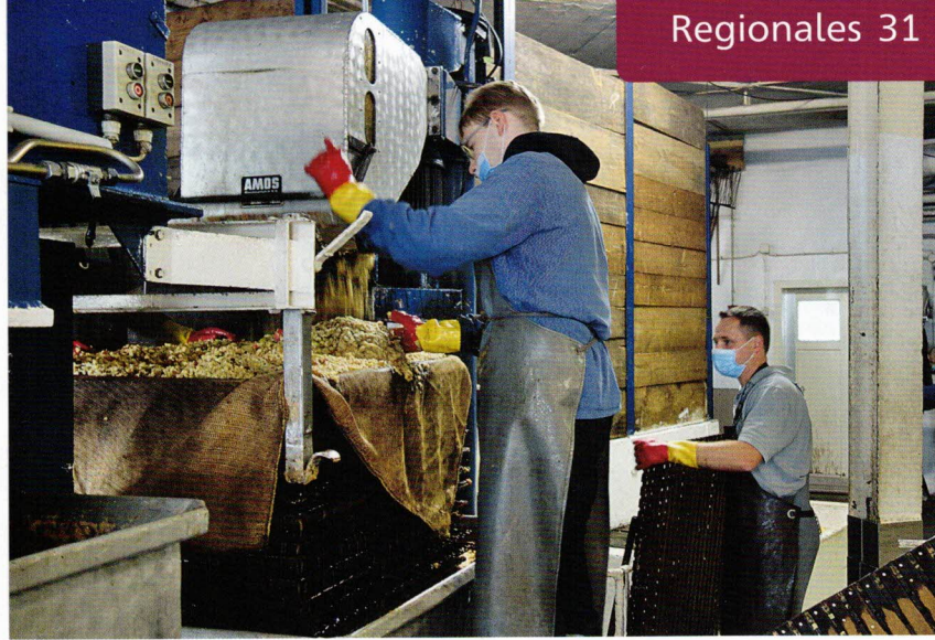
Das geraspelte Obst wird auf Press-Roste gepackt und dann ausgepresst.
